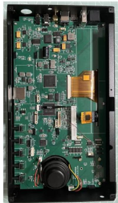
6) Правильно вставьте микропроцессор с двумя радиочастотными чипами на плату, а также радиодиоды J57 и J48 на материнскую плату и установите датчик температуры NTC и аккумулятор. После завершения
