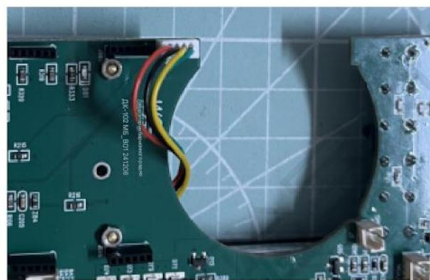
5) Установите плату DK-102\_MB в корпус и затяните винты. (Обратите внимание, что кабели, соединяющие плату OLED и плату DK-102\_MB, должны быть подключены правильно, а кабель динамика должен быть подключен правильно) Процесс завершения показан ниже.
