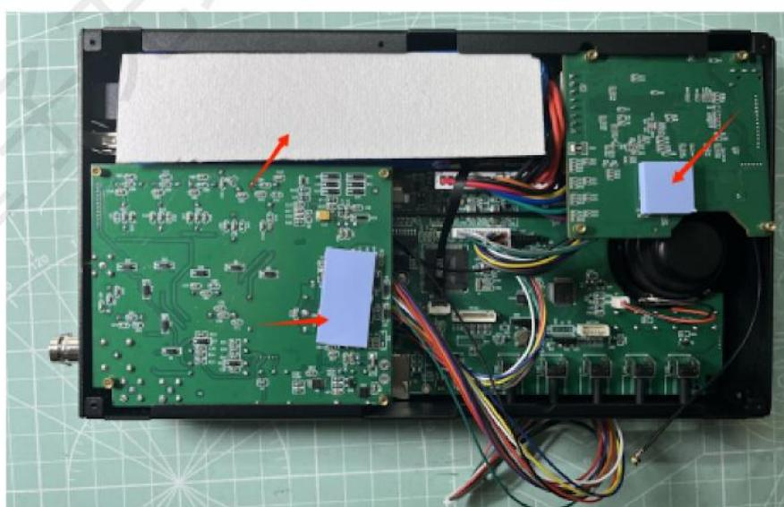
12) Термопрокладка на картинке выше не очень эффективна и может быть заменена на "16,6 Вт теплопроводящий силиконовый лист из нитрида алюминия" ниже. Если вы не замените его, рассеивание тепла может быть плохим.
