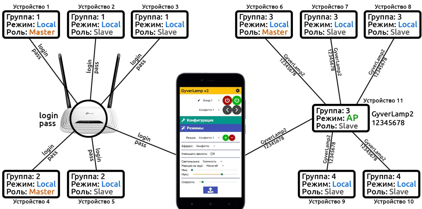
На левой части изображения показан вариант с роутером, устройства с 1 по 5 работают в режиме local и подключены к роутеру. Смартфон также подключается к роутеру для управления всей сетью. На правой части изображения устройства с 6 по 10 работают в режиме local и подключаются к устройству номер 11, которое работает в режиме AP. Для управления сетью смартфон должен подключиться к точке доступа, созданной 11-ым устройством.
