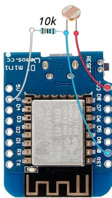
Фоторезистор для автоматического управления яркостью. В приложении выбрать Режим АЦП: Яркость
