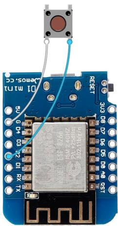
Тактовая кнопка для управления. Если провод длинный - рекомендуется использовать экранированный
